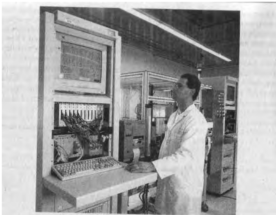
Рис. 10.11. Системы SCXI часто применяются в измерительных приборах, предназначенных для установки в стойке и использующих многоканальные приложения, как показано на этой фотографии
