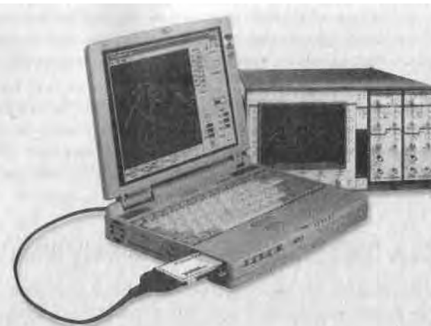
Рис. 10.37. Платы КОП обычно используются для взаимодействия с внешними приборами, такими как осциллограф
